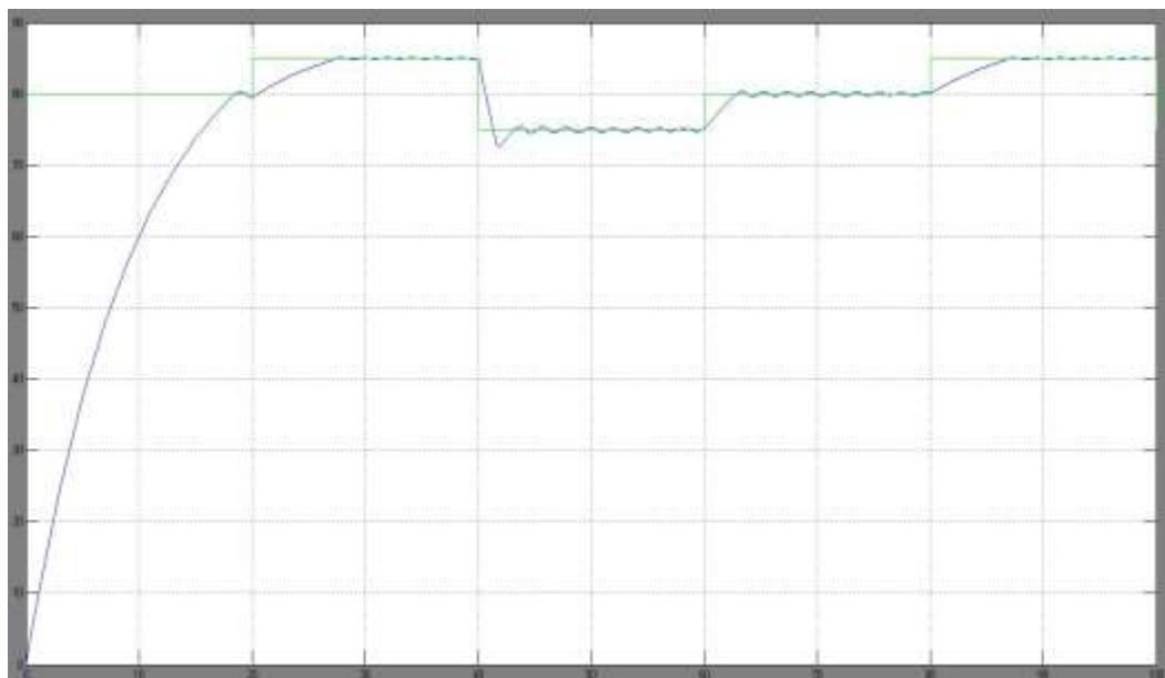
Рисунок 11 – Переходный процесс в САУ температурой нагревательного теплообменника
