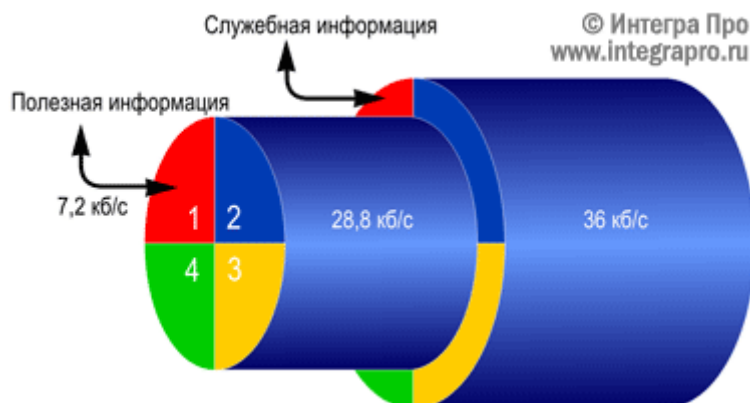
Рис. 3. Формирование общей емкости одного физического канала.
