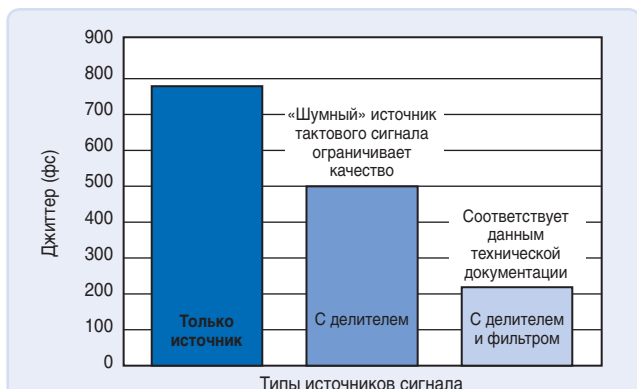
Рис. 9. Уменьшение джиттера за счёт фильтрации и деления частоты
