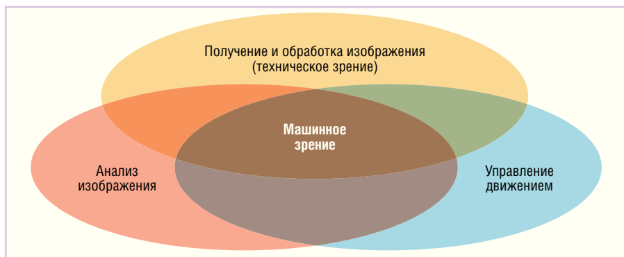
Рис. 1. Элементы технологии машинного зрения
