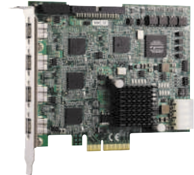
Рис. 9. Плата видеозахвата FIW64 с интерфейсом FireWire 800
