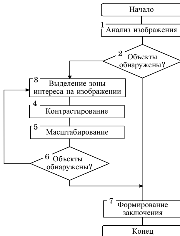
■ Рис. 5. Алгоритм предварительной обработки медицинских изображений, содержащих объекты интереса низкого контраста и малого размера
