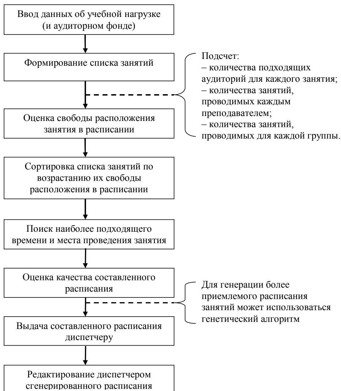
Рисунок 1 – Структурная схема алгоритма составления расписания
