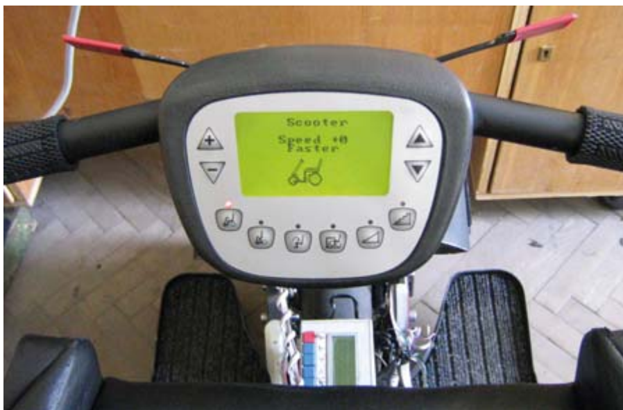
Рис. 6. Современный вариант рулевой головки (пульта управления) транскютера семейства «Кенгуру»
