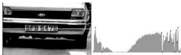
Рисунок 2. Полосный метод локализации номерных знаков.
