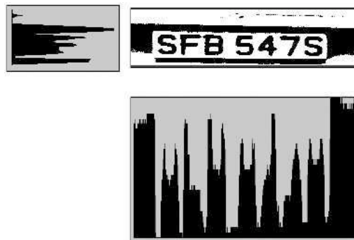
Рисунок 4. Метод «peak-to-valley» для отделения символов номерного знака.
