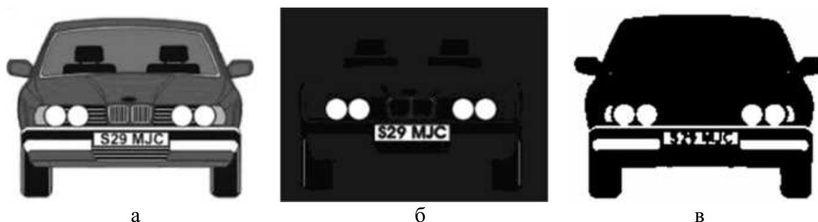
Рис. 2. Предобработка изображения: а) оригинальное изображение, б) с применением ИК-подсветки, в) бинаризованное изображение
