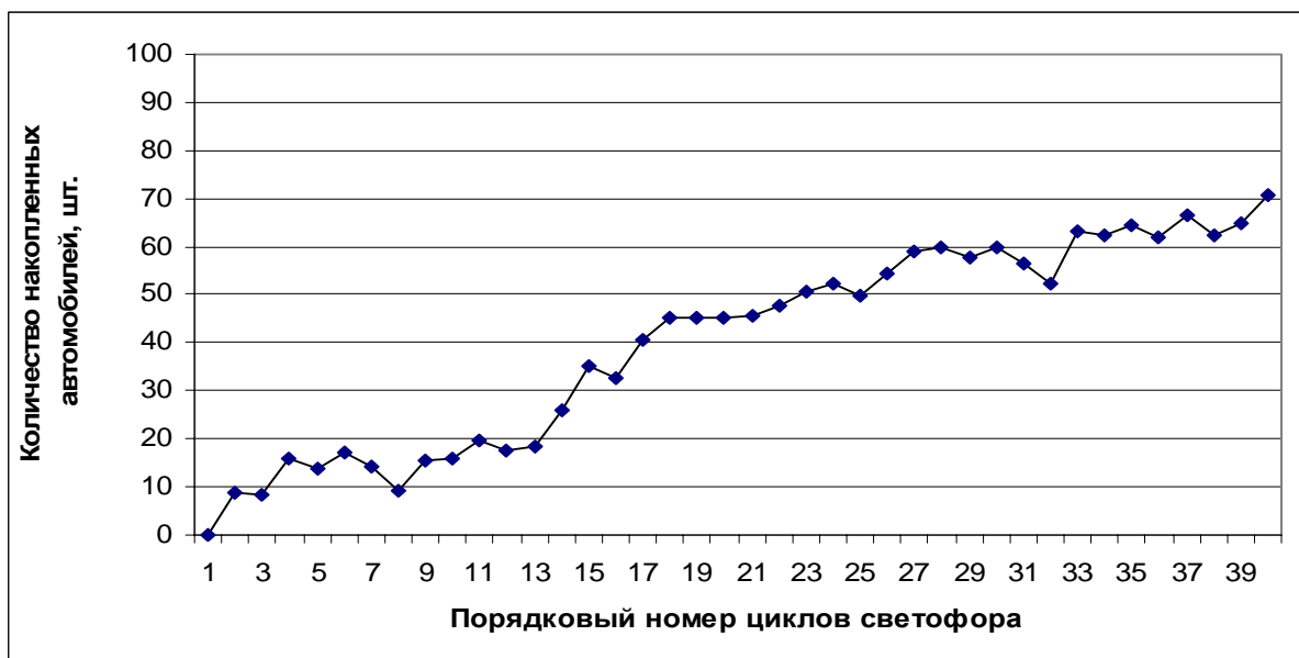
Рис. 2 Розыгрыш модели №2 при K_3=1,1 (расчет по q'_{min} )
