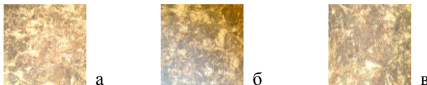
Рисунок 2 – Микроструктура катанки стали 70 после аустенитизации при 900°С в течение 3 мин/мм и охлаждения слабодвижущимся воздухом, ×476: а- центр сечения; б – ½ радиуса; в – 0,5 мм от поверхности
