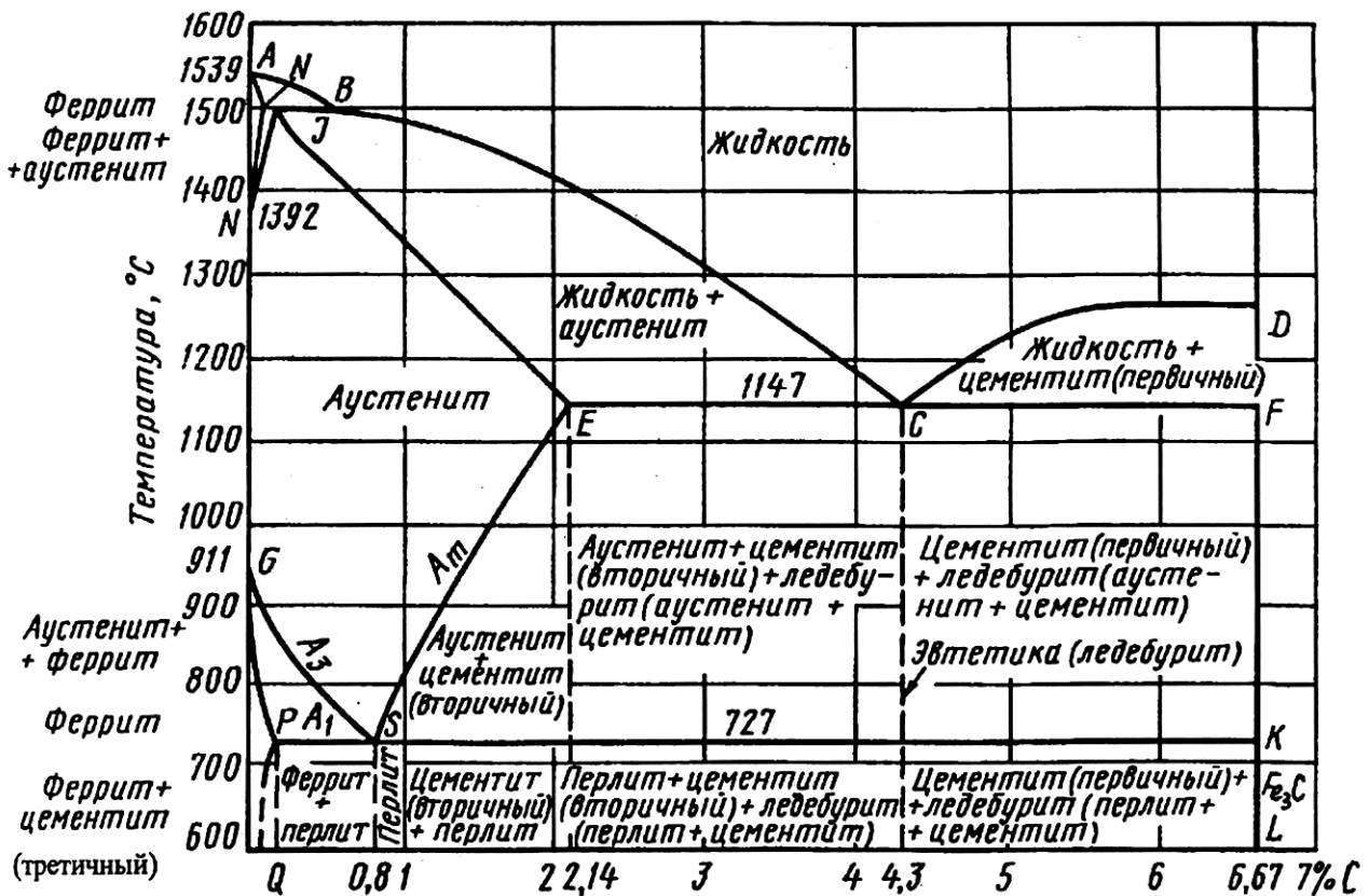
Рис. 6. Диаграмма состояния «железо – цементит»
