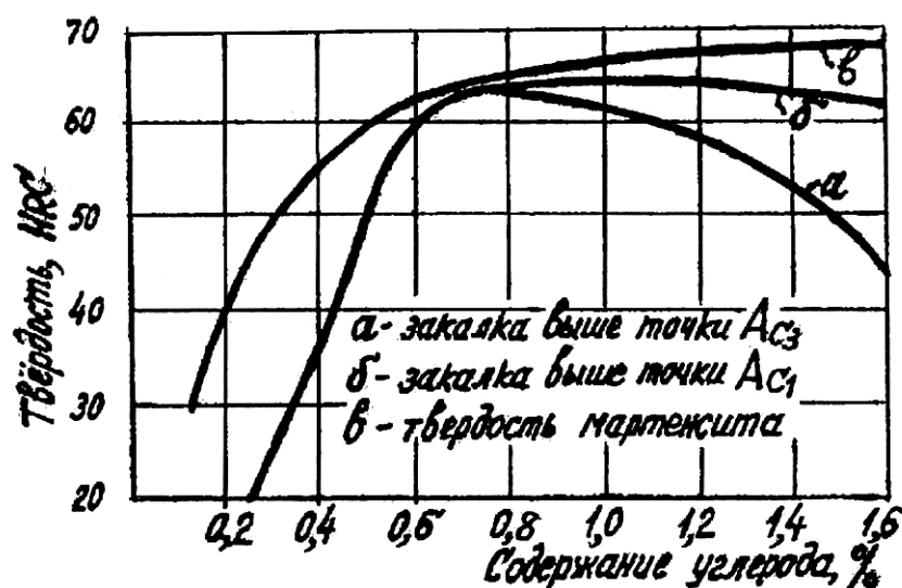
Рис. 3. Влияние содержания углерода и температуры аустенизации на твердость закаленной стали
