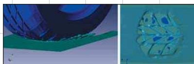
Аквупланирование автомобильной шины (пример задачи на взаимодействие «жидкость — конструкция», ABAQUS + FlowVision)
