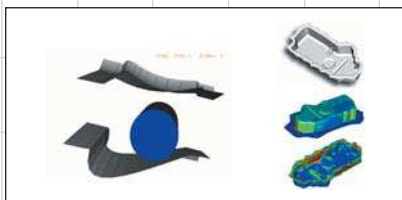
Моделирование процесса штамповки лотка и поковки лопатки двигателя
