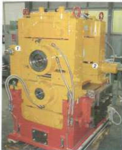
Рис. 12. Предварительно напряженная калибровочная клеть PSG: симметричная и точная настройка межвалкового зазора двумя настроечными винтами (1) и системой с гидравлическим двигателем (2)
