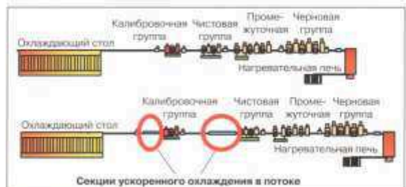
Рис. 3. Прокатка сортового металла с высокой точностью размеров в комбинации с термомеханической обработкой: высокая точность + заданные механические свойства
