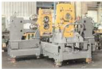
Рис. 5. Быстрая смена валков вне прокатной линии
