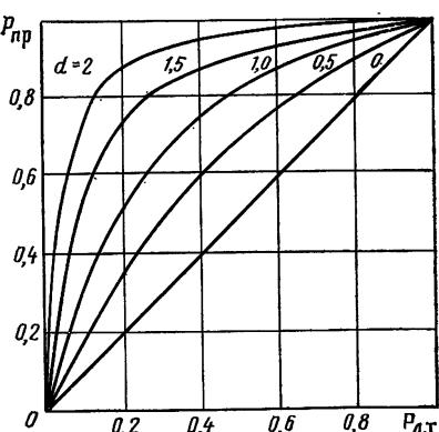
Рис. 14.2. Рабочие характеристики энергетического обнаружителя
