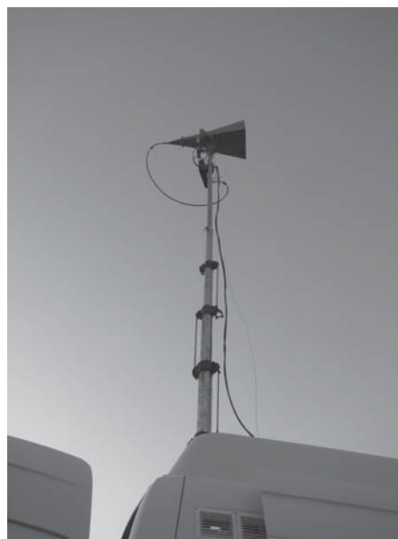
Фото 6. Выносной конвертор АРК-КНВ4 на мачте мобильной станции радиоконтроля вместе с рупорной антенной на дистанционно управляемом поворотном устройстве
