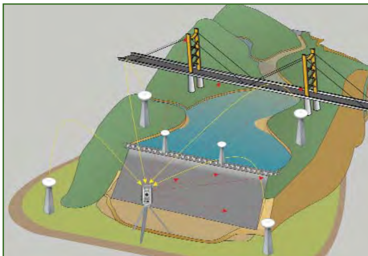
Рис. 1 Принципиальная схема автоматизированного мониторинга в режиме реального времени — Trimble 4D Control
