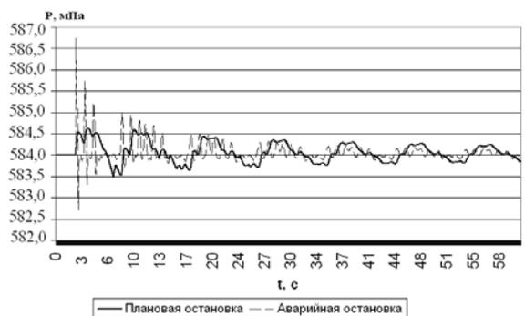
Рис. 11. Зависимость давления пульпы ( $P$ , мПа) от времени ( $t$ , с) при резкой аварийной остановке насосных групп в сечении S1
