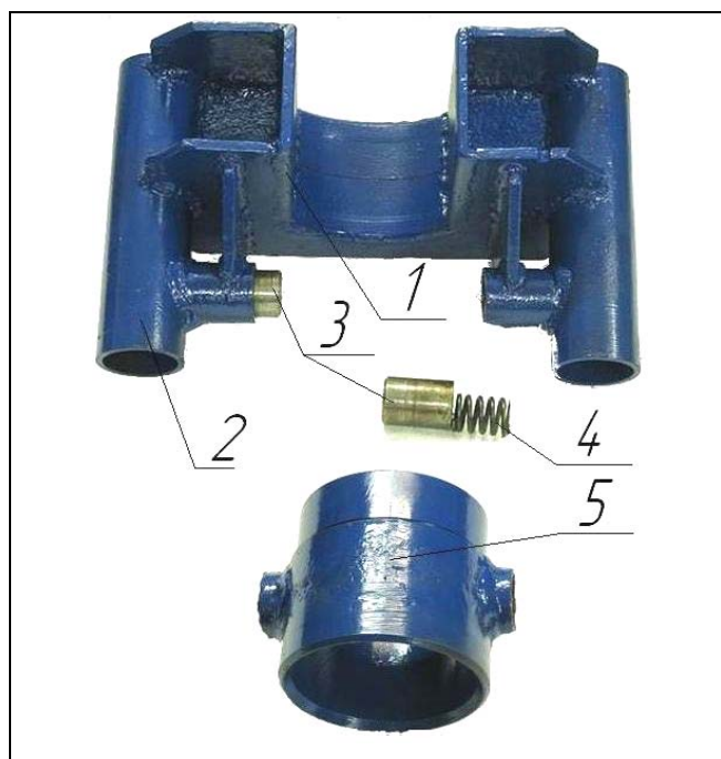
Рис. 3. Элементы подвижной направляющей каретки: 1 - корпус; 2 - направляющие патрубки; 3 - фиксаторы; 4 - пружина; 5 - поворотная воронка
