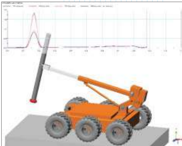
Рис. 10. Моделирование поведения МР при выстреле разрушителя ВУ
