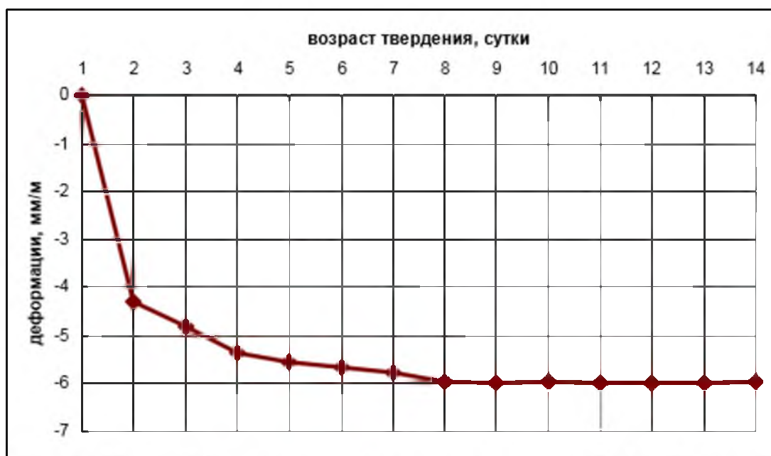
Рис. 1– Усадка фторангидритового вяжущего в мм/м (до 14 суток)
