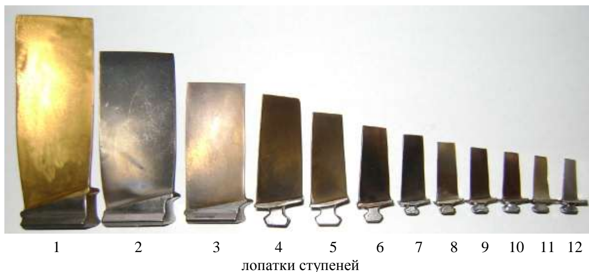
Рис. 1. Общий вид лопаток компрессора ГТД модели ТВ3-117
