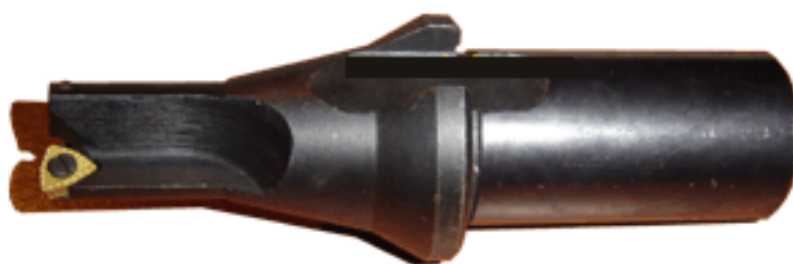
Рис.2 Общий вид сверла с СМП
