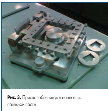
Рис. 3. Приспособление для нанесения паяльной пасты
