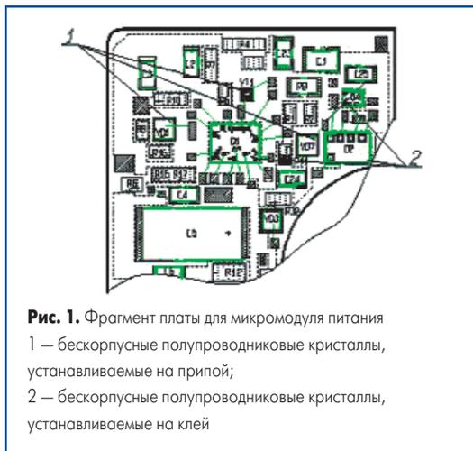
**Рис. 1.** Фрагмент платы для микромодуля питания
