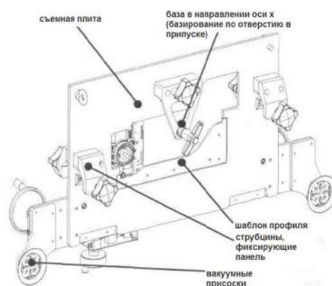
Рис. 7. Шаблон профиля, установленный на съемной плите
