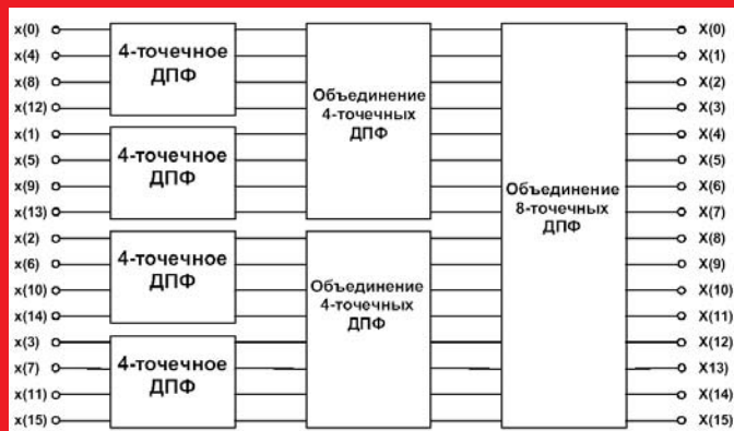
Рис. 6. Поэтапное вычисление БПФ с прореживанием по времени по основанию 4
