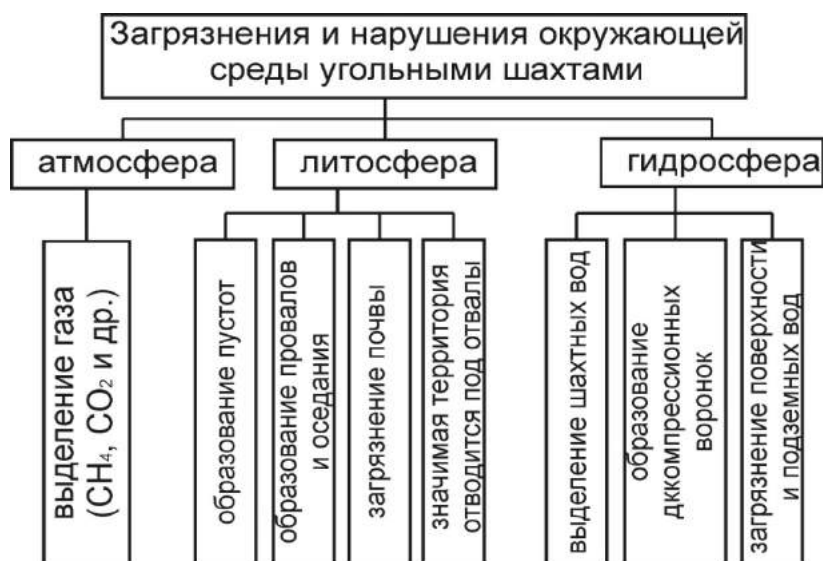
Рис. 1. Схема загрязнения и нарушения окружающей среды угольными шахтами
