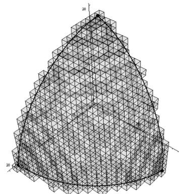
Рисунок 5 - Пример генерации воксельного разложения сферического треугольника
