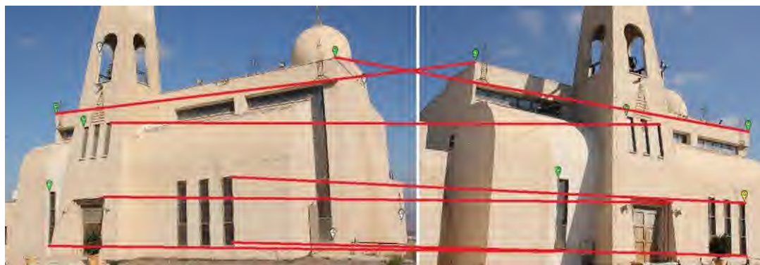
Рис. (4). Красные линии связывают точки привязки на паре изображений. Треугольники в точке показывают, что это контрольные точки с известными координатами на государственной сети.
