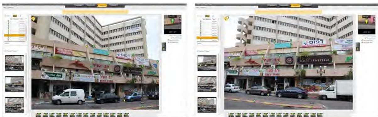
Рис. (15). Пример проекта геодезической съемки фасада здания, который применялся для проверки фотограмметрической модели.
