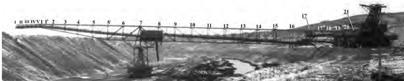
Рисунок 1 – Схема маркировки узлов главной фермы транспортно-отвального моста
