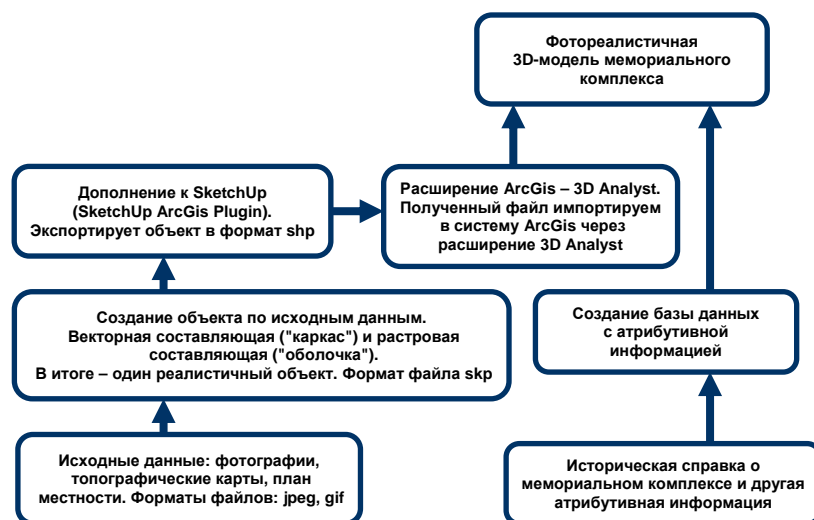
Рис. 1. Функциональная схема создания 3D-модели объекта
