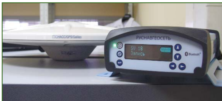
Рис. 1 Инфраструктурный ГНСС-приемник «ФАЗА+» и геодезическая антенна «БОРЕЙ»
