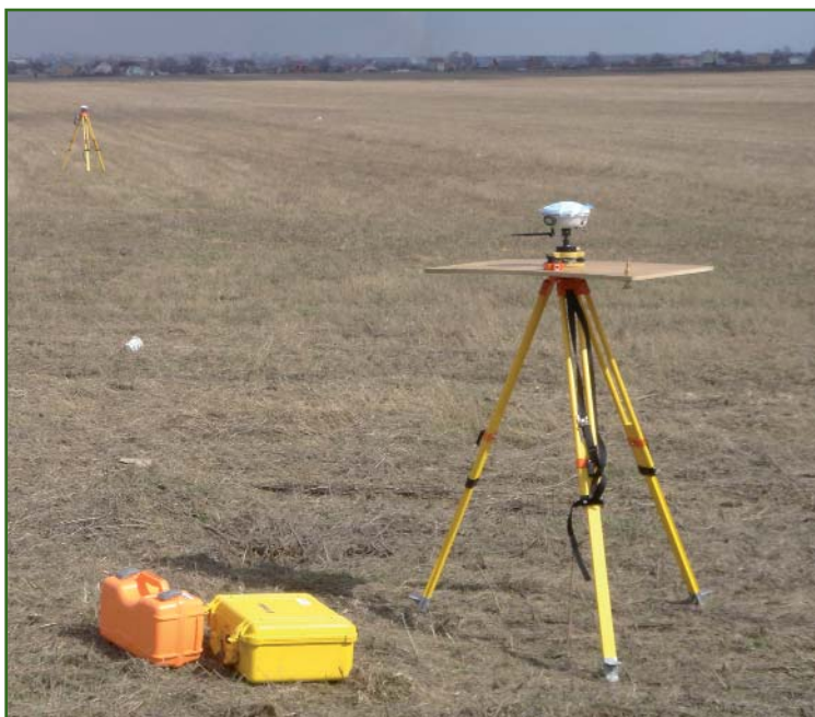
Рис. 5 Контрольный стенд и приемник ГНСС, установленные на базе
