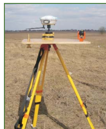
Рис. 4 Приемник Trimble R8GNSS со встроенным GSM-модемом и отражатель
