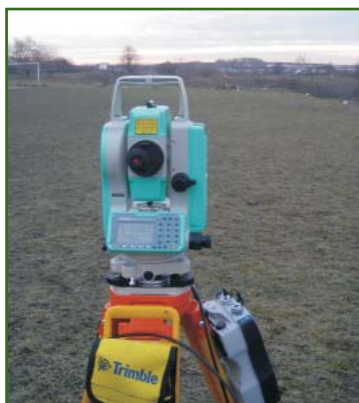
Рис. 2 Тахеометр Nikon NPR332, установленный на базе
