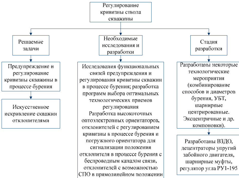
Рис. 5. Схема системы «направленное бурение» – Анализ ситуаций
