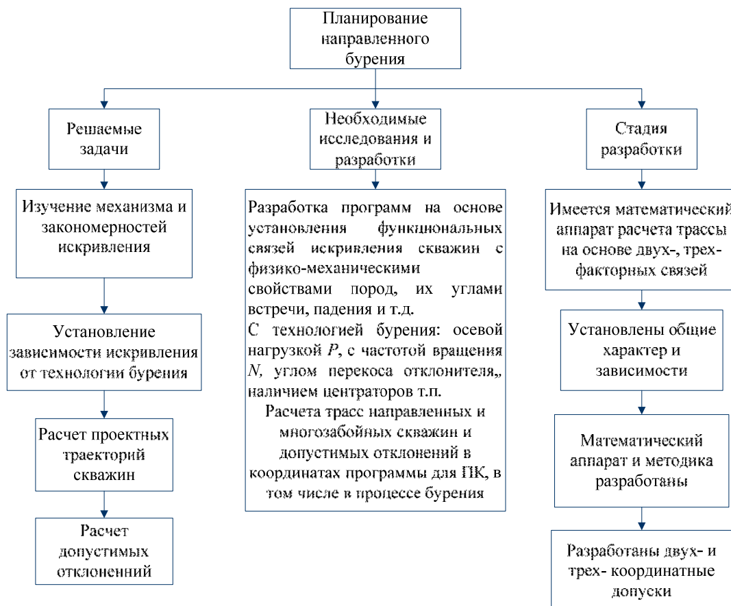
Рис. 2. Схема системы «направленное бурение» – Математическое обеспечение
