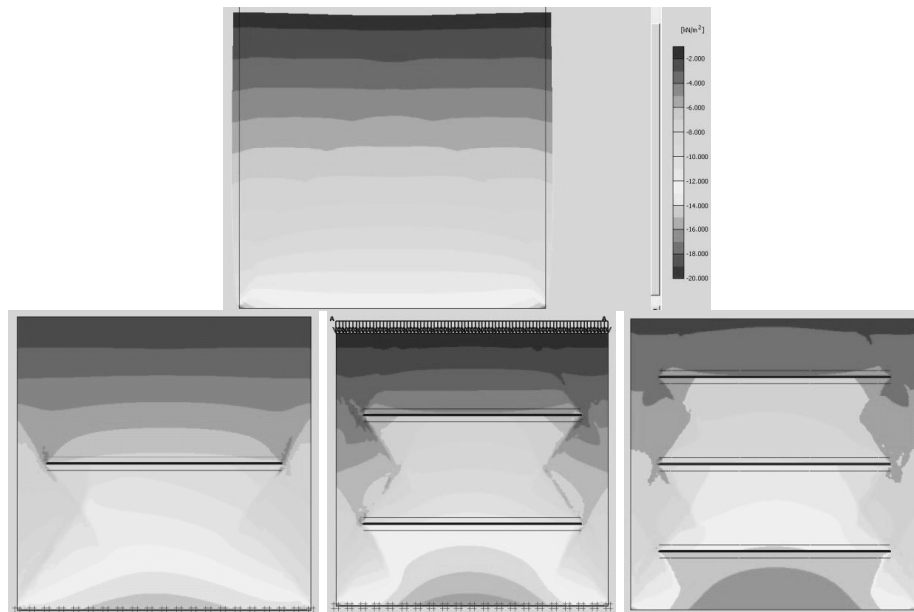
Рисунок 3. Распределение главных напряжений в породных опорах с различным количеством армирующих элементов.
