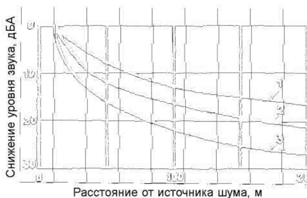
Рис. 2. Снижение уровня звука над разными поверхностями от транспортного потока длиной 20 м: 1 - над асфальтом; 2 - над грунтом; 3 - над газоном
