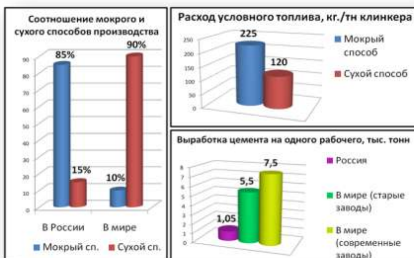
Рис. 6. Соотношение мокрого и сухого способов производства цемента
