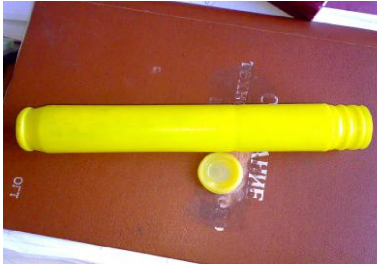
Рисунок 1 – Герметичный патрон угленита в полиэтиленовой оболочке
