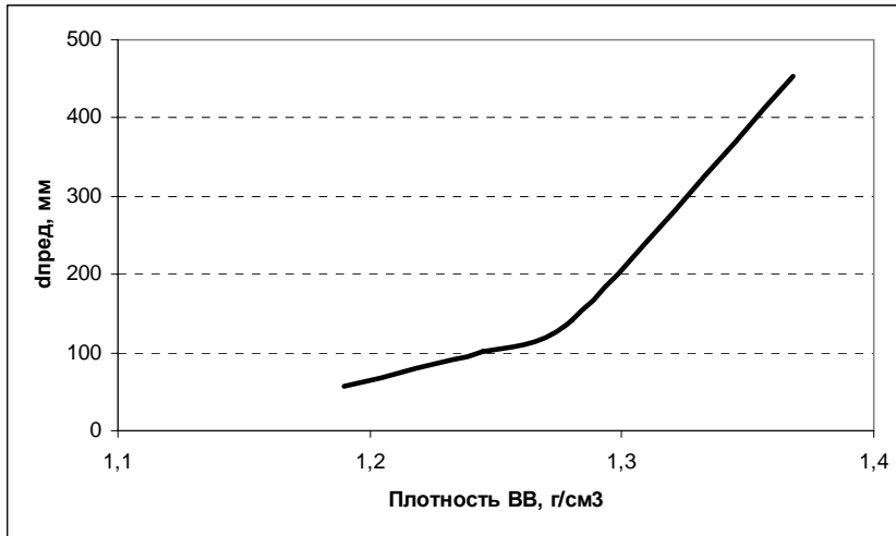
Рис. 3. Зависимость предельного диаметра заряда эмульсии типа Украинита ПП-2 от плотности ( \Delta = 4 мкм, P_{\text{внешн}} = 2,5 атм)
