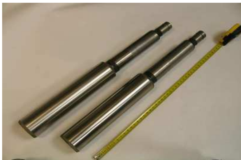
Рис. 4. Шток гидроцилиндра с защитным твердосплавным покрытием, выполненным высокоскоростным газопламенным напылением
