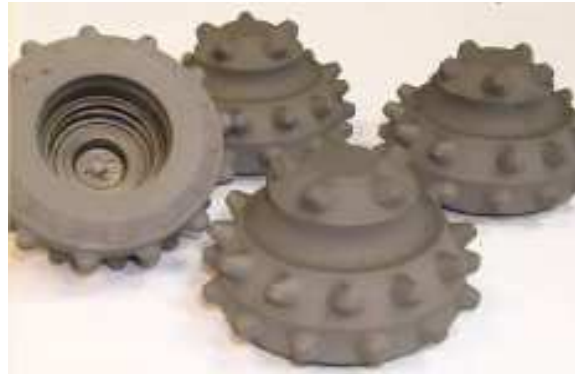
Рис. 6. Упрочненные матрицы шарошки путем высокоскоростного напыления порошков твердых сплавов
