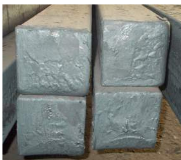
Рисунок 2 – Качество поверхности реза при огневой порезке заготовки
