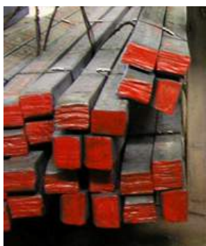
Рисунок 4 – Качество поверхности реза заготовки с низкой температурой при использовании ножниц с прямыми ножами
