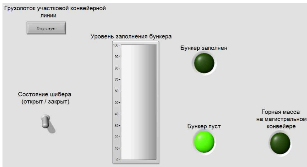
Рис. 2. Передняя панель (бункер пуст, грузопоток отсутствует)
