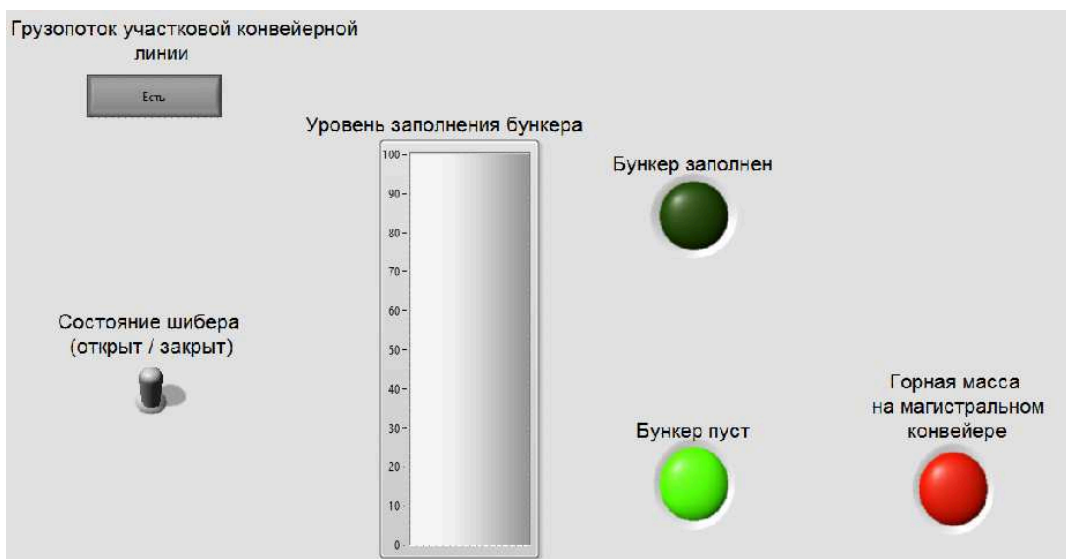
Рис. 6. Передняя панель (бункер разгружен, грузопоток есть)
