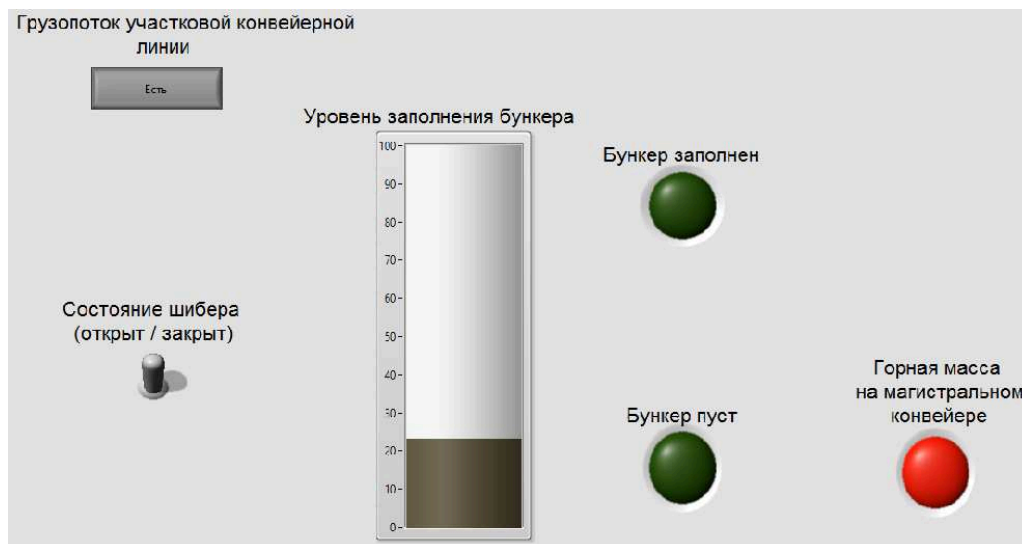
Рис. 5. Передняя панель (процесс разгрузки бункера)
