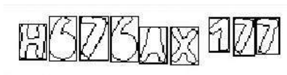
Рис. 9. Найденные контуры символов автомобильного регистрационного знака
