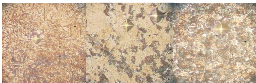
Рисунок 2 – Микроструктура проволоки после сорбитизации в сыпучем графите, с, \times 160 : а) 1, б) 6, в) 9 при температуре 950°С
