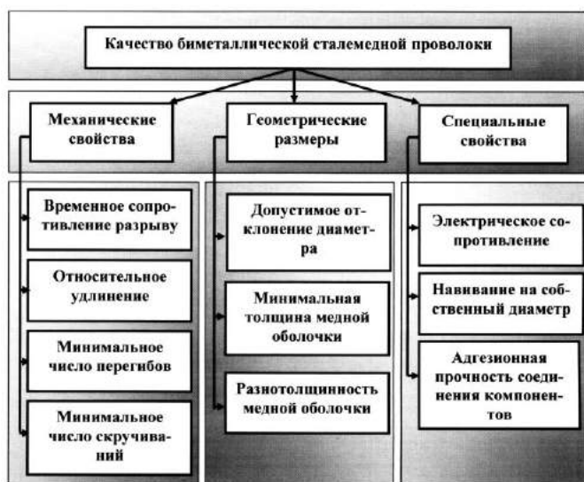
Рис. 1. Структура качества сталемедной проволоки
