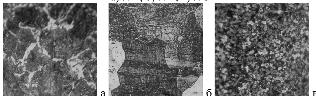
Рисунок 2 – Микроструктуры образцов игл после отжига, ×476: а) №1; б) №2; в) №3
