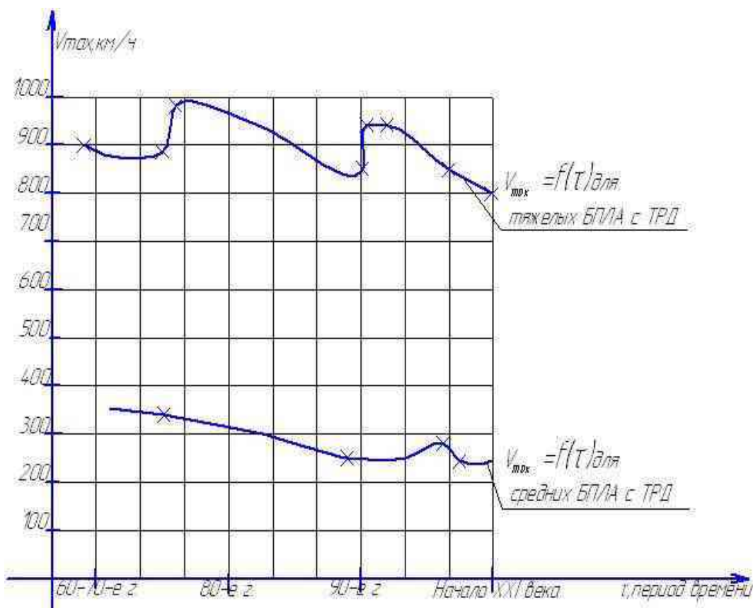
Рисунок 4 - Изменения m_{взл.} и V_{max} в различные периоды для БПЛА с ТРД.
