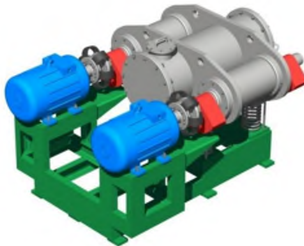
Рис. 2. 3D-модель экспериментального образца вибромельницы
