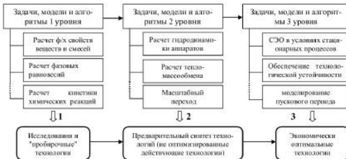
Рис. 1. Уровни моделирования при создании новых и модернизации действующих производств
