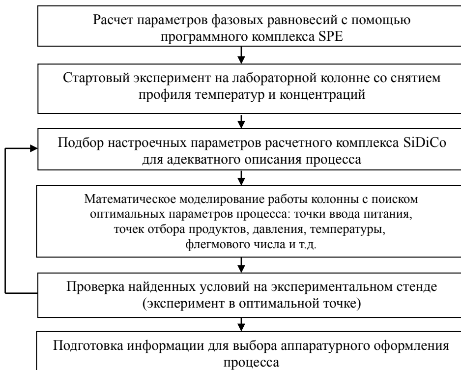
Рис. 6. Последовательность работ при имитационном моделировании
