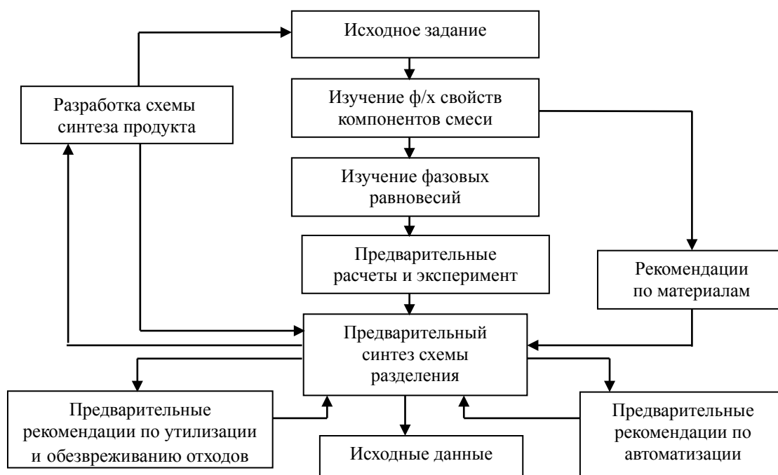
Рис. 3. Основные виды работ и их взаимосвязь при предварительном синтезе ТВХП
