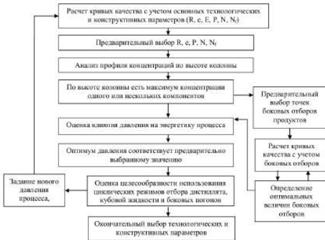
Рис. 3. Алгоритм оптимизации одноколонных аппаратов непрерывного действия
